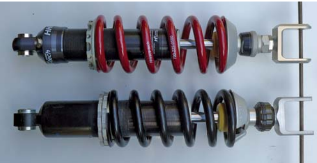
Unten: HH Race-Tech und Original-Federbein im Vergleich.
